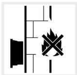
Wechselrichter auf nicht entflammbarer Montagefläche montieren.
