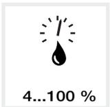
Die Luftfeuchtigkeit muss zwischen 4 % und 100 % (kondensierend) liegen.
