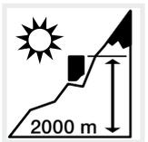
Wechselrichter darf nur bis zu einer Höhe von 2000 m montiert werden.
