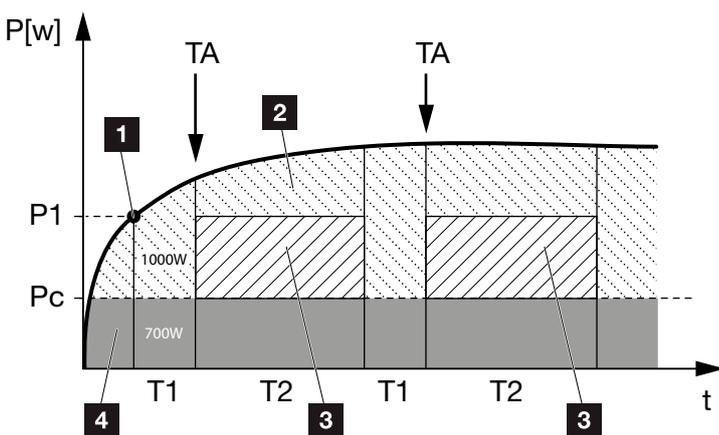
Abb. 65: Kurve Dynamischer Eigenverbrauch (Funktion 1)
