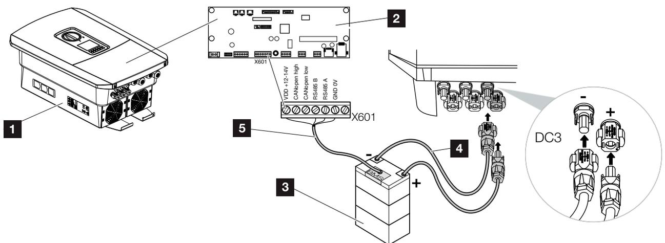
Abb. 35: Anschluss Batteriespeicher
