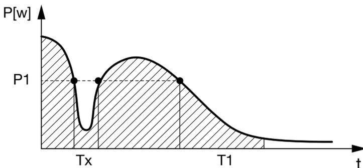
Abb. 68: Kurve Verzögerung bei Leistungsabfall / Störung
