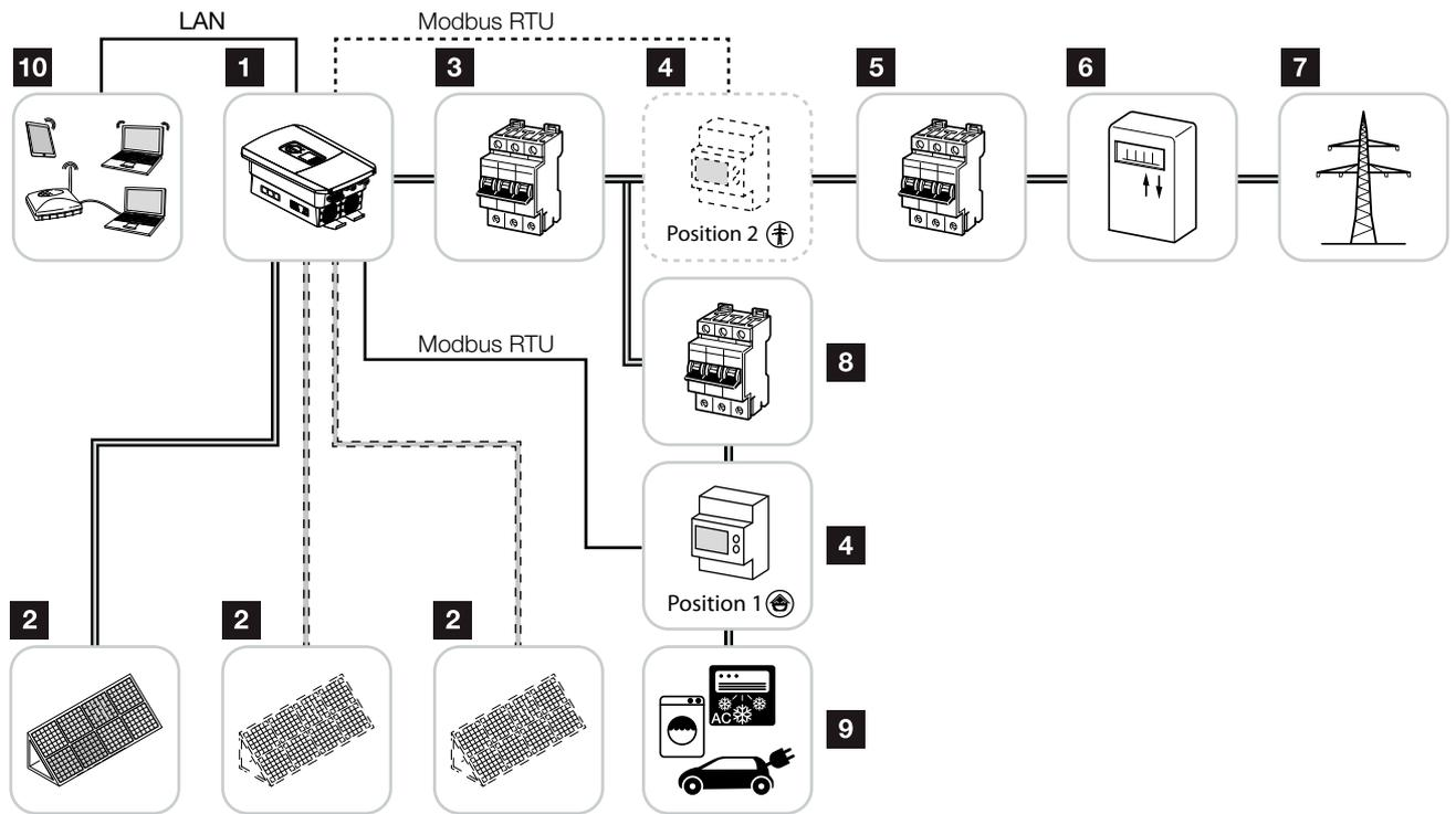
Abb. 7: Photovoltaikanlage mit 3 PV Eingängen
