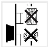
Wechselrichter auf stabiler Montagefläche montieren, die das Gewicht sicher tragen kann. Gipskartonwände und Holzverschalungen sind nicht zulässig.
