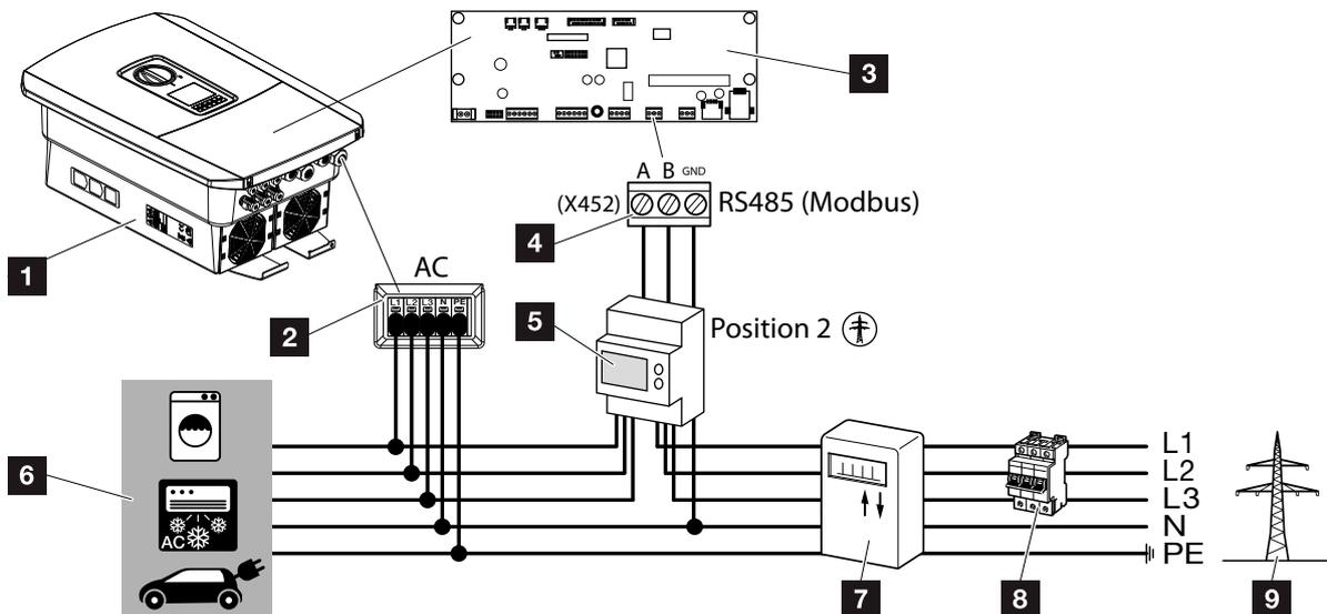
Abb. 28: Anschlussplan Energiezähler - Netzanschluss (Position 2)
