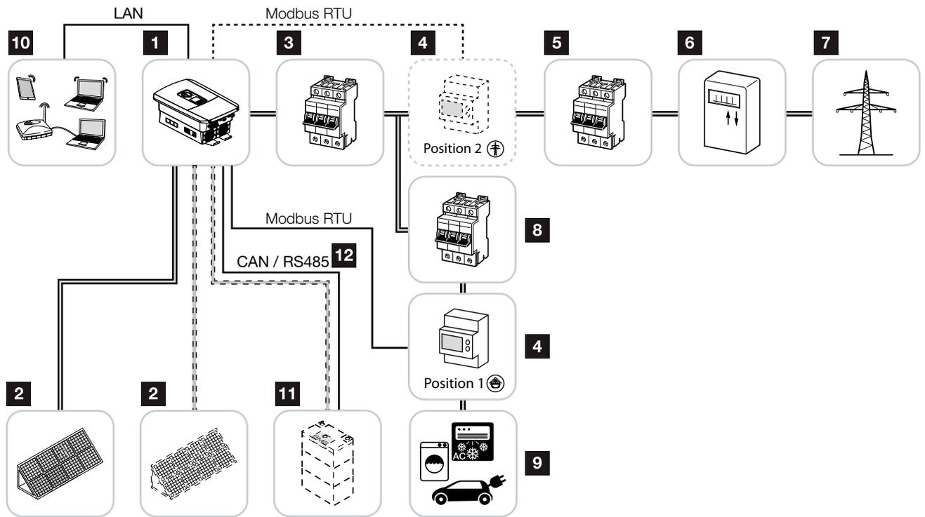
Abb. 8: Photovoltaikanlage mit PV und Batterieanschluss
