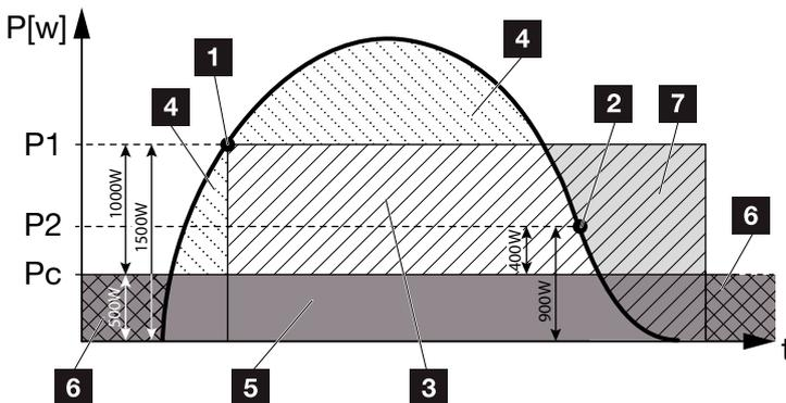
Abb. 67: Kurve Dynamischer Eigenverbrauch (Funktion 2)
