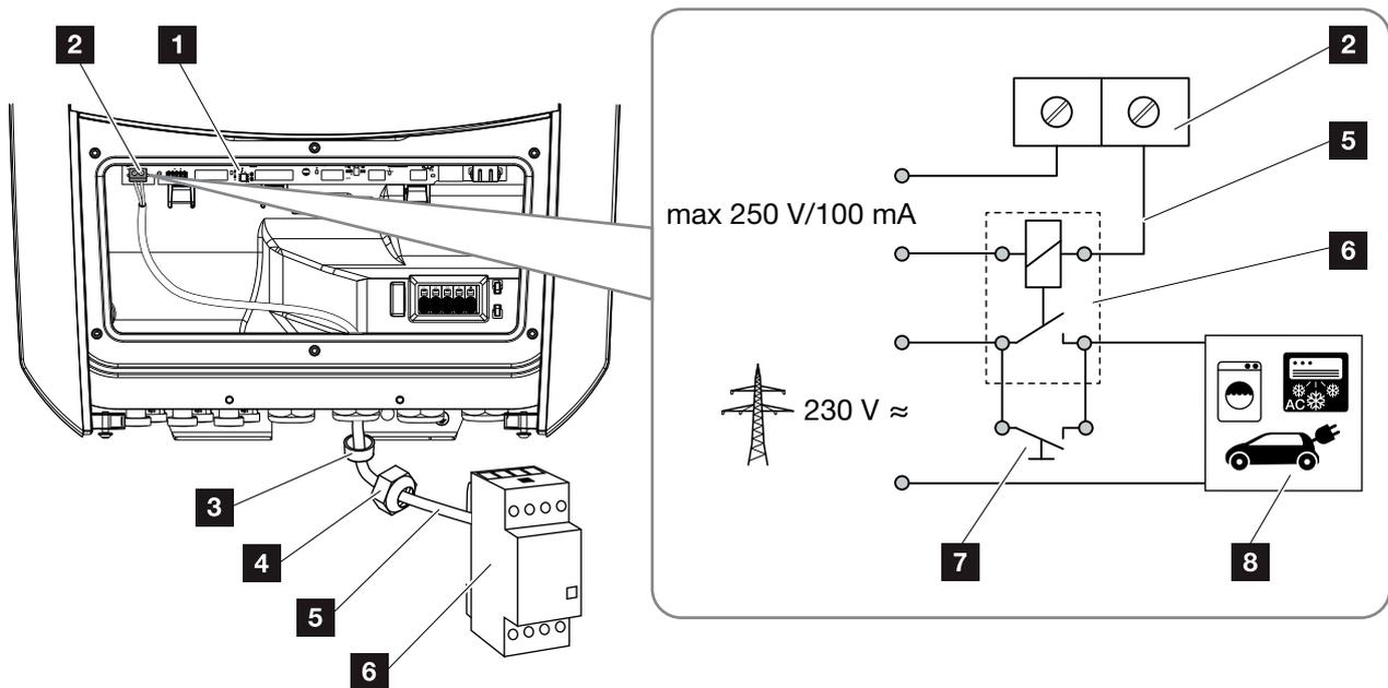
Abb. 62: Elektrischer Anschluss Eigenverbrauch
