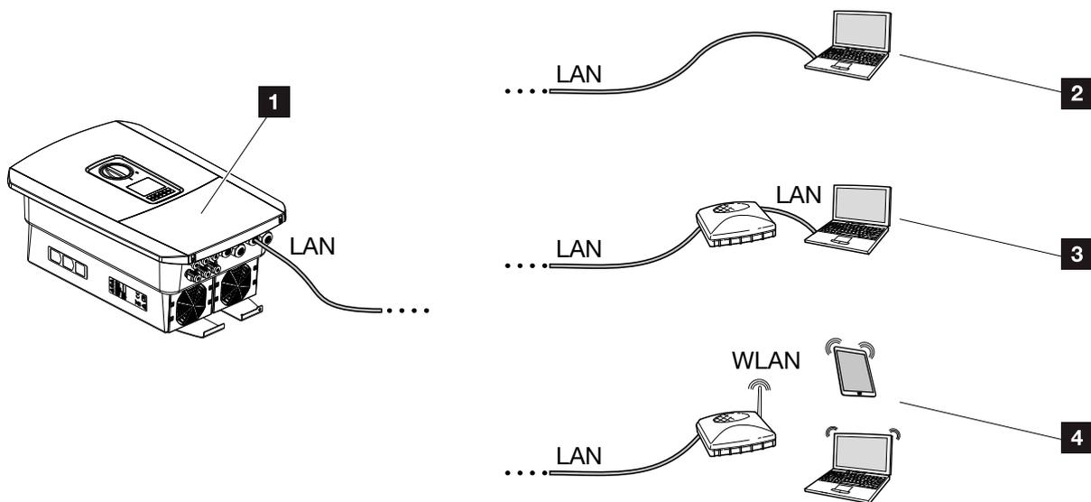
Abb. 50: Anbindung von Computer an den Wechselrichter
