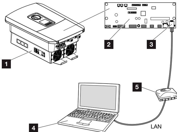
Abb. 51: Wechselrichter und Computer mit Ethernet-Kabel verbinden
