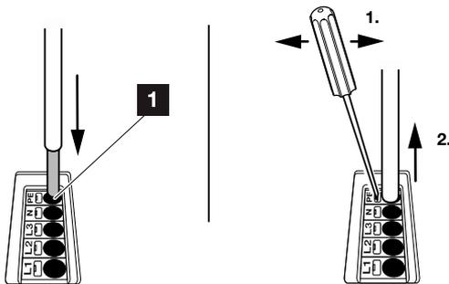
Abb. 24: Federzug-Klemmleiste
