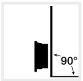
Wechselrichter auf senkrechter Montagefläche montieren.
