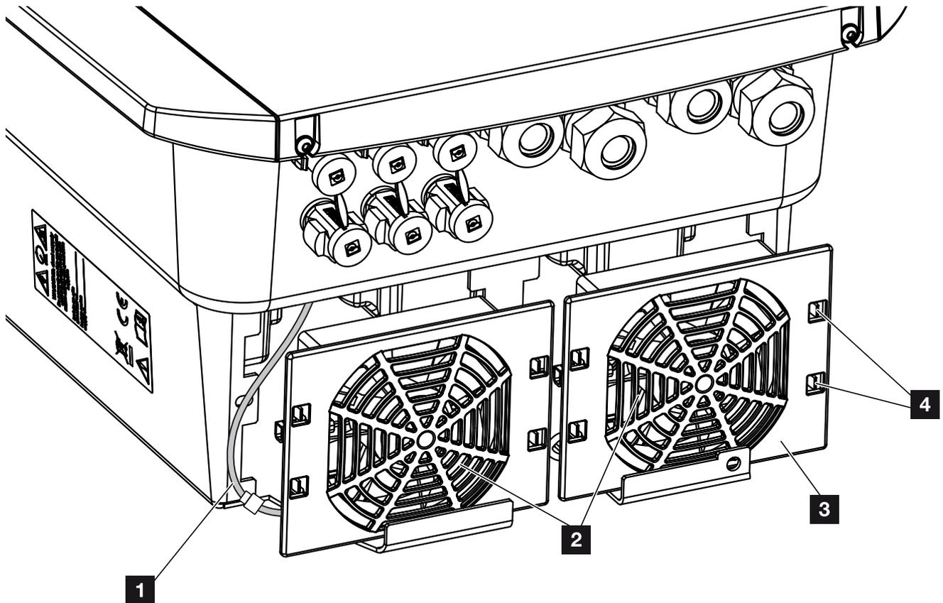
Abb. 69: Lüfterausbau Übersicht
